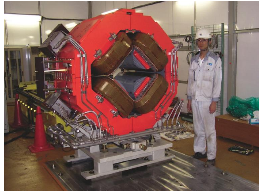
Magnete quadrupolare per il focheggiamento
